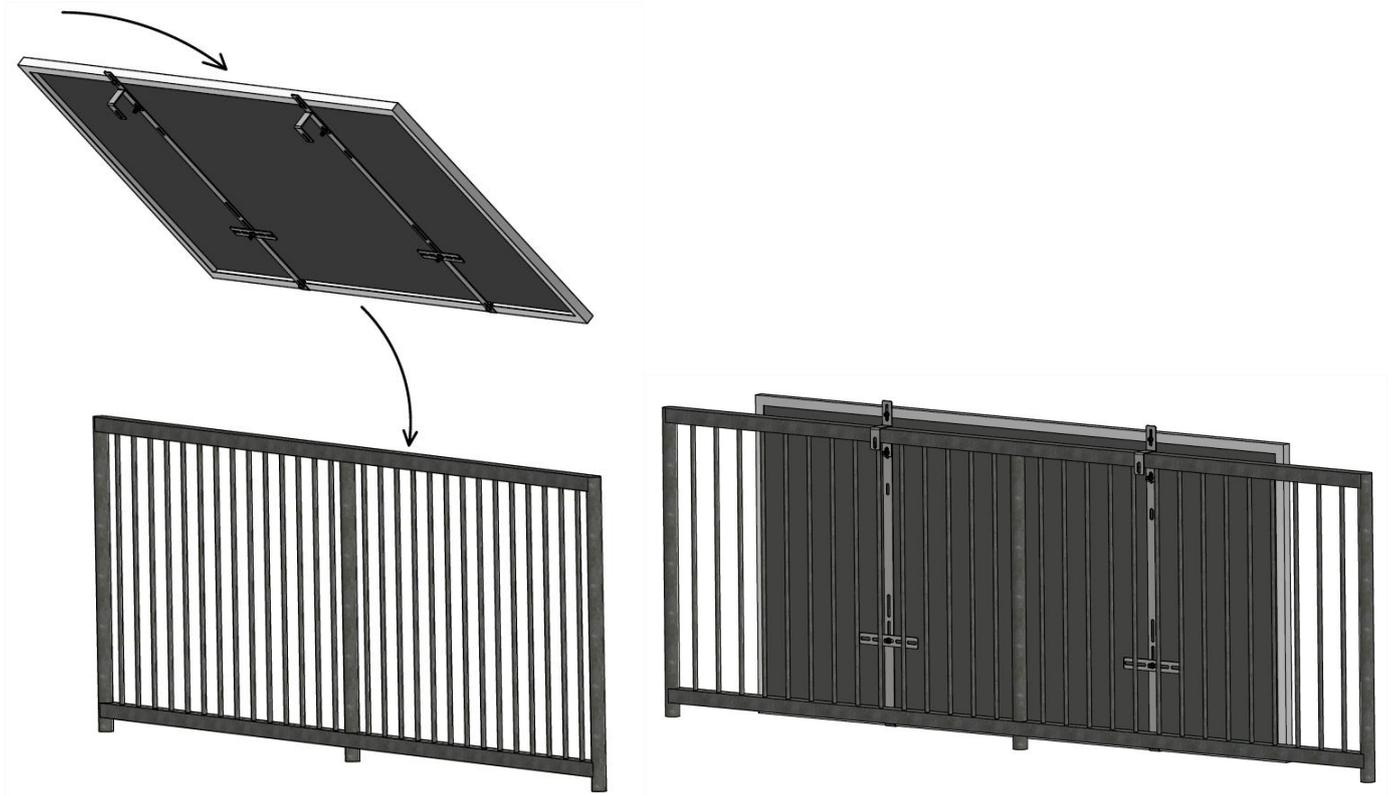
ABB.7 Montage der Struktur auf der Balustrade
