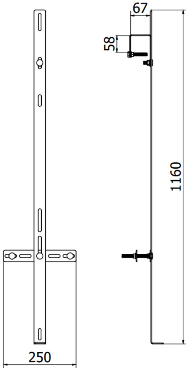
Abb. 1 Konstruktionsabmessungen
