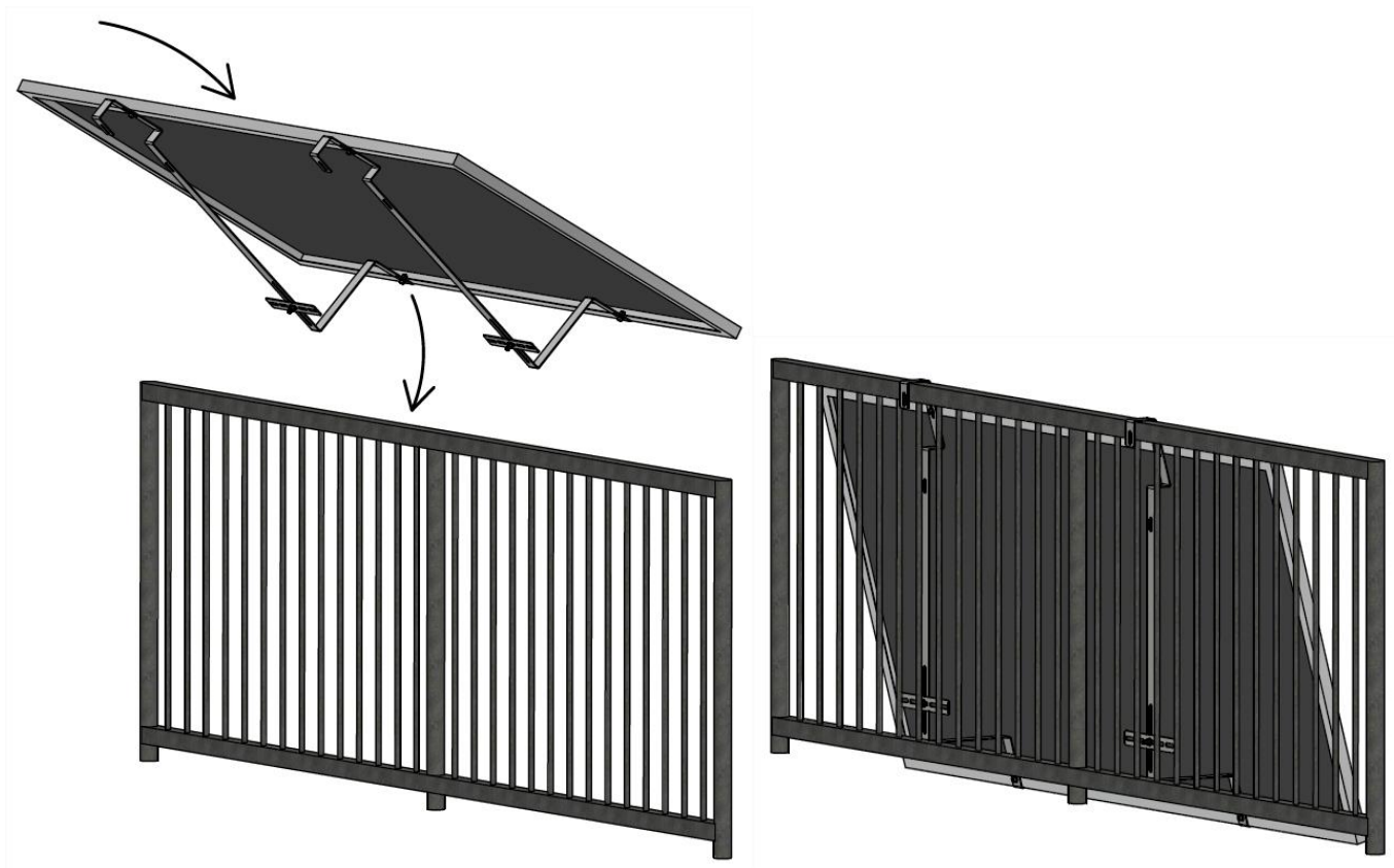
ABB.9 Montage der Struktur auf der Balustrade
